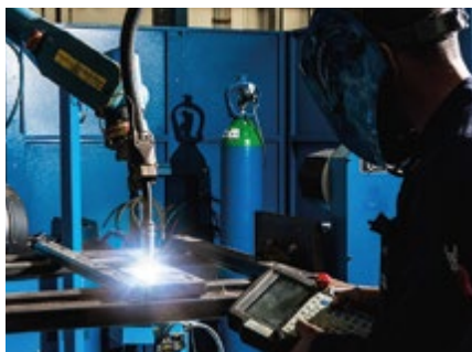
Zrobotyzowane spawanie MAG
