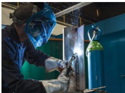
Spawanie MAG stali nierdzewnej
