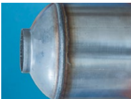
Układ wydechowy z ferrytycznej stali nierdzewnej
